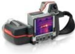
La collection de physique a fait l'acquisition d'une **caméra thermographique FLIR T200** pour utilisation pédagogique. Cette caméra permet d'enregistrer des photographies sous format JPEG afin de procéder ultérieurement à des mesures physiques ( logiciel fourni) . Une sortie Vidéo permet de procéder à des projections par vidéoprojecteur pour des démonstrations en amphi.
